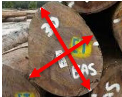
Afbeelding 5: Indien hout niet cilindrisch is dient er langs de langste zijde de eerste diameter gemeten te worden en daarna de tweede diameter loodrecht daarop.
