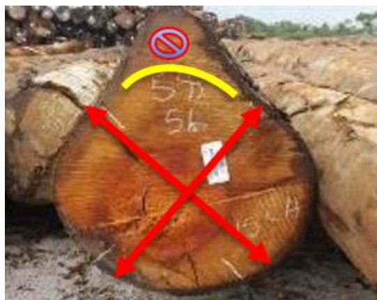
Afbeelding 7: Enkele voorbeelden van hoe de diameters gemeten dienen te worden (rode pijltjes).
