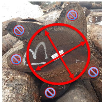
Afbeelding 6: Bij de diameter meting moet een blok met plankwortels als een cirkel beschouwd worden, waarbij de plankwortels niet meegenomen worden in de meting.
