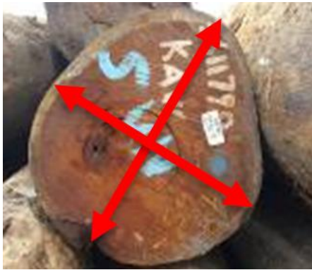
Afbeelding 5: Indien hout niet cilindrisch is dient er langs de langste zijde de eerste diameter gemeten te worden en daarna de tweede diameter loodrecht daarop.
