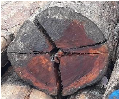
Afbeelding 14: In het geval dat hout uit elkaar is gespleten, dan mogen deze spleten afgetrokken worden bij de diameter meting.
