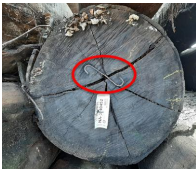
Afbeelding 16: S haken dienen gebruikt te worden om hout splijting te voorkomen
