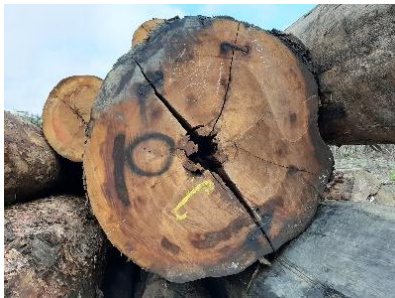
Afbeelding 15: In het geval dat er spleten voorkomen, maar het hout niet uit elkaar is gespleten, dan wordt dit als een gebrek gezien en wordt het alleen afgetrokken als het gebrek doorloopt tot de andere kant van het blok.
