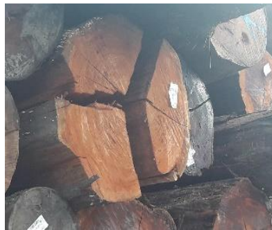
Afbeelding 14: In het geval dat hout uit elkaar is gespleten, dan mogen deze spleten afgetrokken worden bij de diameter meting.
