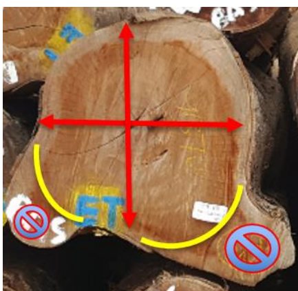
Afbeelding 7: Enkele voorbeelden van hoe de diameters gemeten dienen te worden (rode pijltjes).
