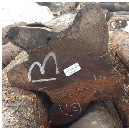
Afbeelding 6: Bij de diameter meting moet een blok met plankwortels als een cirkel beschouwd worden, waarbij de plankwortels niet meegenomen worden in de meting.
