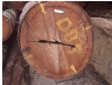
Afbeelding 15: In het geval dat er spleten voorkomen, maar het hout niet uit elkaar is gespleten, dan wordt dit als een gebrek gezien en wordt het alleen afgetrokken als het gebrek doorloopt tot de andere kant van het blok.
